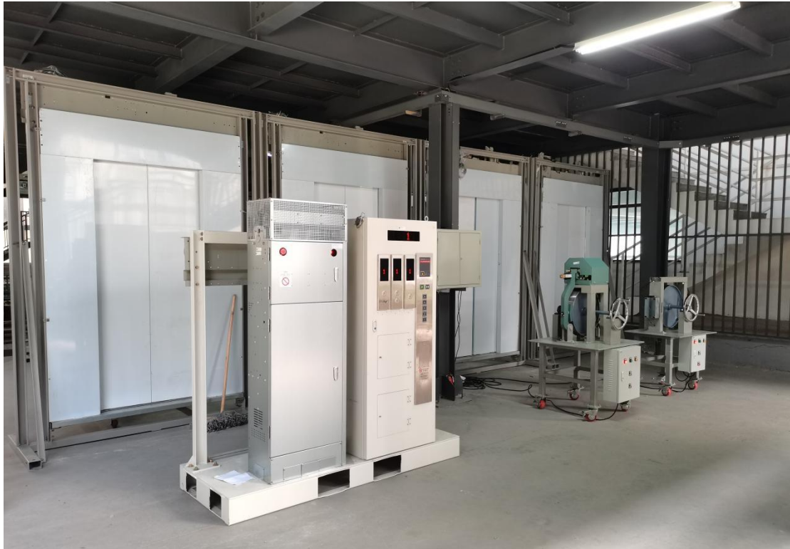
图 7: 电梯模拟故障控制柜与全真制动器模拟系统
